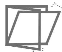
LES OSCILLO-BATTANTS 1 OU 2 VANTAUX Ventilation et ouverture totale. Cumulent les avantages des soufflets et des ouvertures à la française
